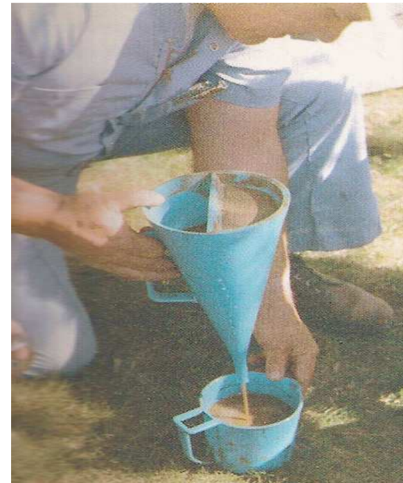
Medición de la Viscosidad del Lodo (Tiempo de llenado en segundos)
